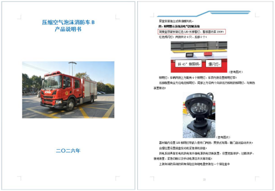
驾乘室顶部安装红色 LED 长排警灯，警报器功率 200W；
